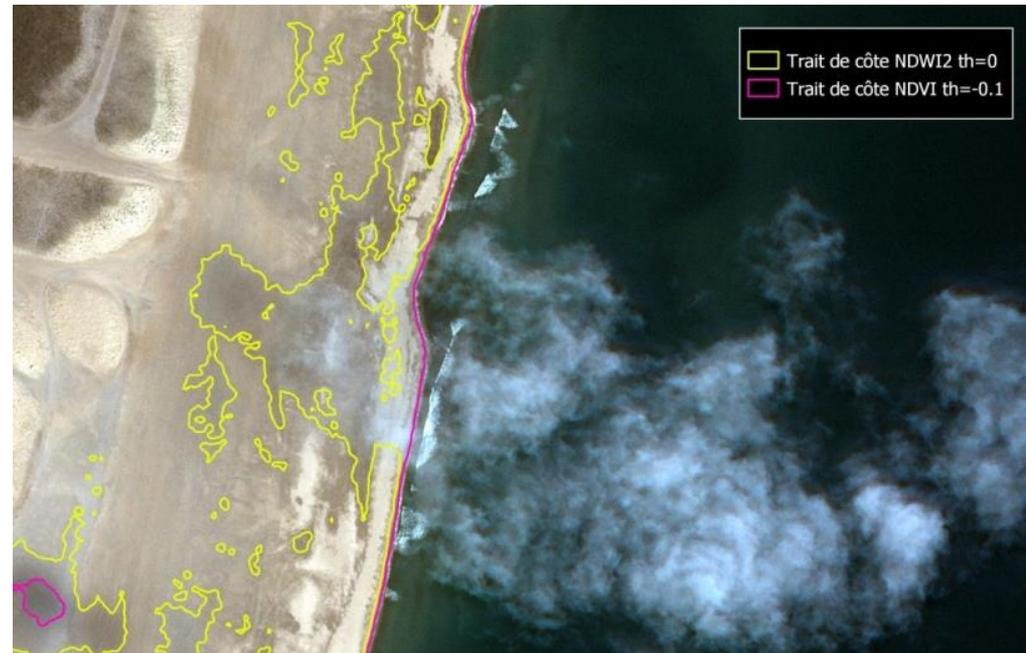
Il s'est avéré qu'un simple seuillage sur des indices de type NDVI (mieux que NDWI) permettait d'ajuster de manière plus rapide et plus efficace le « modèle » afin qu'il détecte la limite plage-mer à la condition du jour et au site
